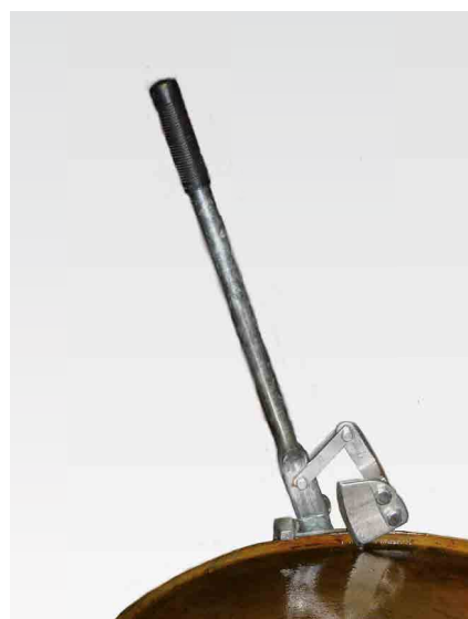
Cesoia aprifusti Cesoia aprifusti Sheet metal cutter for opening drums
